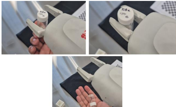
Fig. 18. Pruebas físicas del gripper en recolección y liberación del objeto
