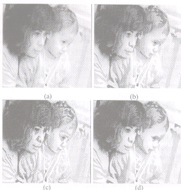
Figura 11. (a) Imagen original, (b) Mapeo de contraste de 2 estados a nivel píxel con \lambda = 30 , (c) Aplicación secuencial de mapeos de contraste de 2 estados a nivel píxel con tamaños \lambda_1=10 , \lambda_2=20 , \lambda_3=30 , (d) Aplicación secuencial de mapeos de contraste de 2 estados sobre partición con tamaños \lambda_1=6 , \lambda_2=12 , \lambda_3=18 (mismo resultado obtenido al aplicar el mapeo de contraste sobre particiones solamente con parámetro \lambda=18 )
