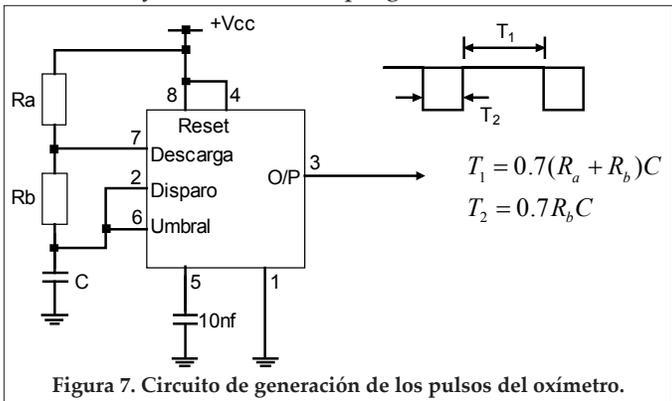
Figura 7. Circuito de generación de los pulsos del oxímetro.
