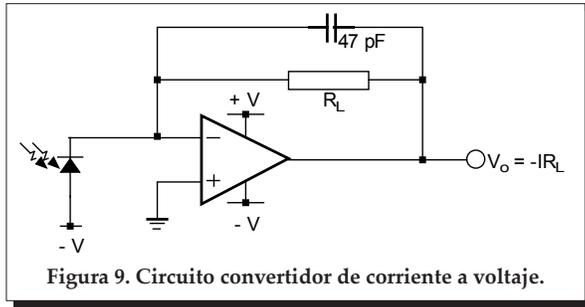
Figura 9. Circuito convertidor de corriente a voltaje.
