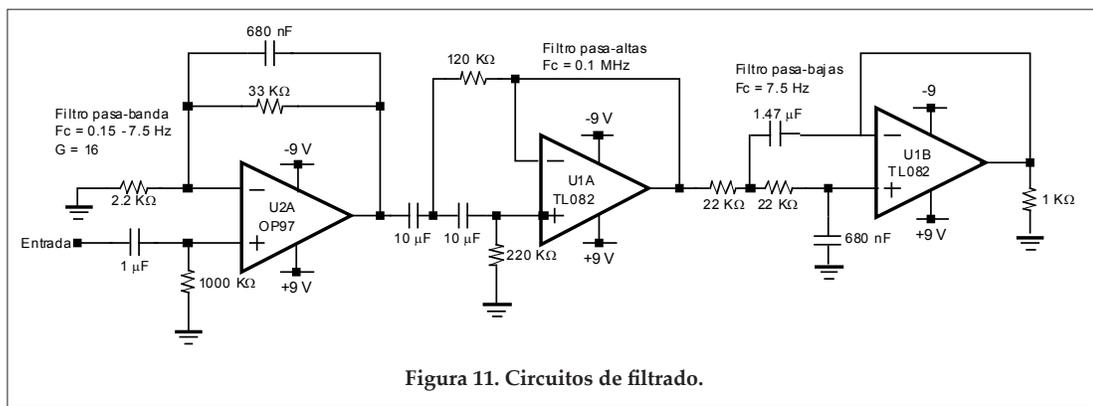
Figura 11. Circuitos de filtrado.
