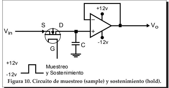
Figura 10. Circuito de muestreo (sample) y sostenimiento (hold).
