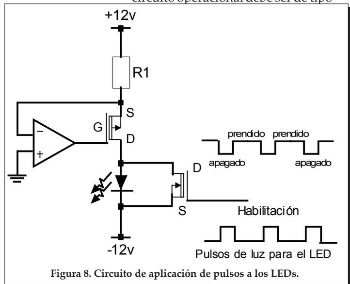
Figura 8. Circuito de aplicación de pulsos a los LEDs.
