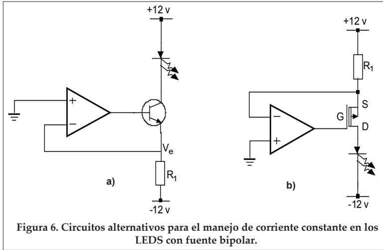
Figura 6. Circuitos alternativos para el manejo de corriente constante en los LEDs con fuente bipolar.
