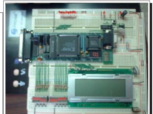
Figura 13. Tarjeta con interfaces de entrada y salida.
